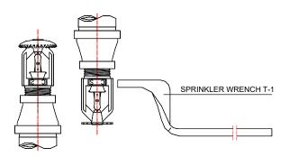
FIGURE D : SPRINKLER WRENCH SELECTION & USE
